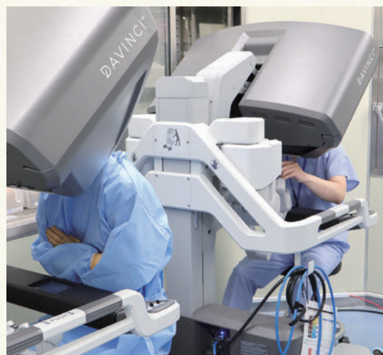
▲ダヴィンチの動きをコントロールする「司令塔」ともよべるサージョンコンソール
